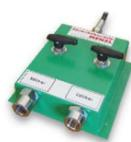
Der externe Anschluss wird neben dem Prüfgerät montiert und erleichtert das An- und Abschrauben des Pressluftatmers vor bzw. nach der Prüfung. Mit zwei Sperrventilen kann zwischen 200 und 300 bar umgeschaltet werden. Der 200-bar-Anschluss ist zusätzlich mit einem Sicherheitsventil ausgestattet.
