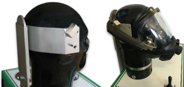
Sonderzubehör: Prüfvorrichtung aus Edelstahl für das besonders komfortable Prüfen von Zweipunktmasken
