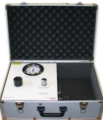
Das Manometer hat einen Durchmesser von 100 mm und eine Skalierung mit Feineinteilung, sodass Prüfergebnisse mit großer Genauigkeit ablesbar sind. Zudem verfügt es über eine Kalibrierschraube zur Nullpunkt Korrektur des Zeigers.
