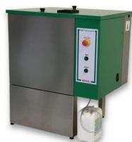
Für die Reinigung, Desinfektion und Trocknung von max. 9 Atemschutzmasken in ca. 3,5 Stunden (mit Sonderzubehör können gleichzeitig auch bis zu 9 Lungenautomaten behandelt werden). Automatischer Programmablauf mittels SPS-Steuerung. Automatische Zumischung des Desinfektionsmittels, variabel von 0,2 % bis 2 % einstellbar. Trocknung mittels Warmluftgebläse bei max. 50 °C.
