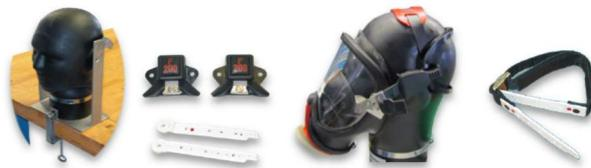
Füllleitung und Prüfleitung für die Dichtprüfung von Chemikalienschutanzügen. Ventilprüfeinheit mit Ausgleichsbehälter für die Dichtprüfung der Ausatemventile.
