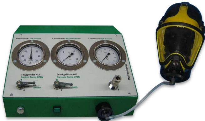
Die Druckanzeige erfolgt über Manometer, die einen Durchmesser von 100 mm und eine Skalierung mit Feineinteilung haben, sodass Prüfergebnisse mit großer Genauigkeit ablesbar sind. Zudem verfügt das Niederdruckmanometer über eine Kalibrierschraube zur Nullpunkt Korrektur des Zeigers.
